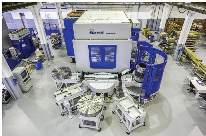
affrontare materiali come il titanio e le superleghe (HRSA, come Inconel 718 e Waspaloy) utilizzati in particolare nell'Aerospace per le loro caratteristiche meccaniche e per la resistenza alle alte temperature di esercizio, Mandelli ha introdotto sia innovazioni strutturali sia innovazioni SW per garantire un'elevata produttività e precisione.
