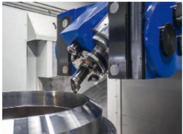
**La nuova Spark 2100, sviluppata per una lavorazione completa tornitura/fresatura**
