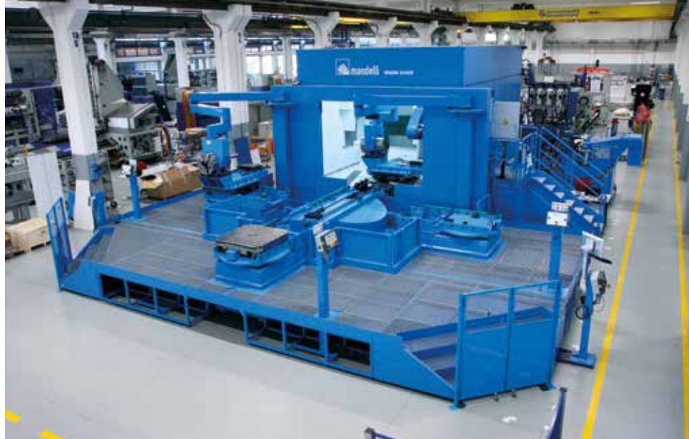
Sopra: la Mandelli Spark 2100X in configurazione a 3 pallet
