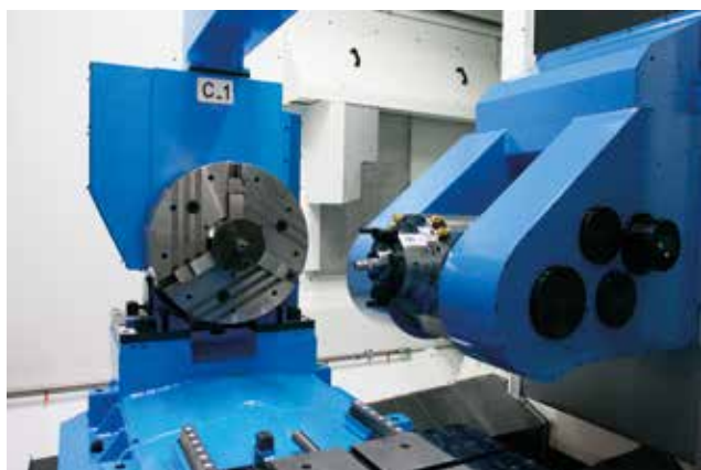
I fori sull'albero vengono eseguiti in interpolazione tra l'asse mandrino e quello del divisore, entrambi dotati di motori lineari
