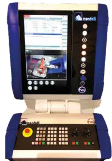
In apertura: l'elevata sensorizzazione dei centri di lavoro Mandelli consente di ottenere significativi vantaggi legati all'IoT Sotto a sinistra: iPredict permette di prevedere un futuro fermo macchina Sotto a destra: iControl è il nuovo pannello operatore con schermo touch da 22"
