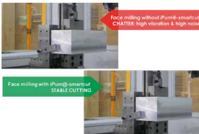
Differenza della qualità superficiale ottenibile con iSmartcut
