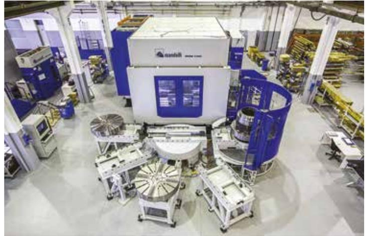
bene Baureihe Spark Ti wurde speziell für Werkstoffe wie Titan und Superlegierungen (HRSA, wie Inconel 718 und Waspaloy) entwickelt, die aufgrund ihrer mechanischen Eigenschaften und ihrer hohen Temperaturbeständigkeit vor allem in der Luft- und Raumfahrt Verwendung finden. Bei dieser Werkzeugmaschinenbaureihe hat
