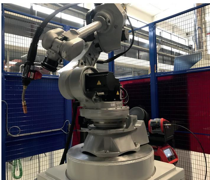
Sopra, da sinistra: la stazione di AM utilizza un braccio antropomorfo della Comau "vestito" con una unità saldante Fronius di ultima generazione
