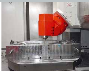
Das Bearbeitungszentrum Umill 1800 von Emco bei der 5-Achs-Simultan-Bearbeitung einer Spritzgußform. Das BAZ verfügt über einen Achsenverfahrweg von 1.800 x 2.150 x 1.250 mm.
